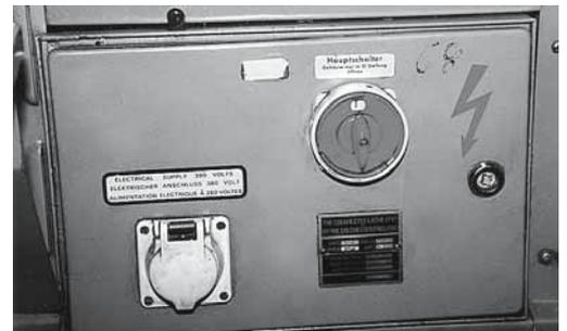
Bild 2: Für optimale Sicherheit bei Wartungsarbeiten muss der Hauptschalter mit einem Vorhängeschloss abschliessbar sein.
