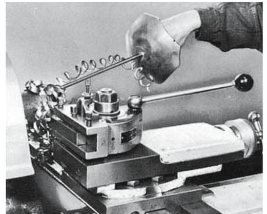
Bild 9: Um die Späne zu entfernen, ist ein Spänehooken mit Handschutz zu verwenden.
