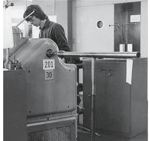
Bild 8: Die Stangenführung hält die Stange beim Drehen.
