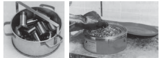
Mit Tauchkorb und Handschuhen kann der Hautkontakt mit Lösemitteln oder Schmiermitteln vermieden werden.
