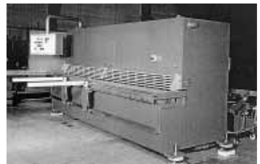
Bild 4: Zur Verhütung von Finger- und Handverletzungen muss die Schnittlinie auf der ganzen Länge des Messerbalkens mit einer stabilen Schutzeinrichtung geschützt sein.
