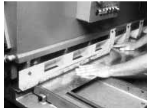
Bild 3: Die Schutzeinrichtung ist so angeordnet, dass nicht unter den Niederhalter gegriffen werden kann.
