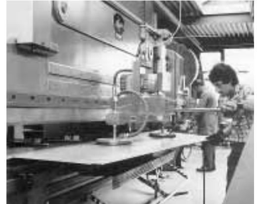
Bild 1: Vakuümheber an einer Blechbearbeitungsmaschine.
