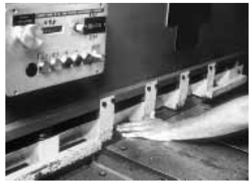
Bild 5: Schutzeinrichtung mit Griffmulde und guter Sicht auf die Schnittlinie, was auch das Zuschneiden kleiner Blechteile erlaubt.
