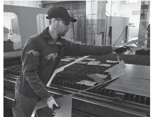
Bild 1: Mitarbeiter trägt Schutzhandschuhe mit einer Schnittfestigkeit  $\geq 3$  bei der Handhabung von scharfkantigen Blechen.
