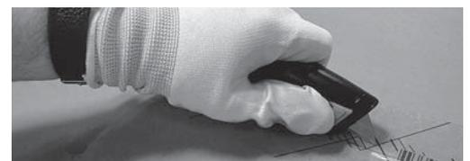
Bild 4: Sicherheitsmesser mit Klingenrückzug zum Aufschneiden von Verpackungen.
