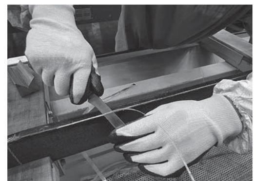
Bild 9: Einseitig beschichtete Schnittschutzhandschuhe bieten guten Haut- und Schnittschutz bei Tätigkeiten mit leicht öligen und scharfkantigen Teilen.
